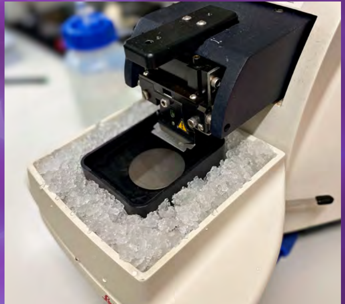
B: Gerät mit vibrierender Rasierklinge(Vibratom, Lieca) zur Herstellung von sehr dünnen Gewebeschnitten zur Etablierung einer Gewebeschnittkultur
